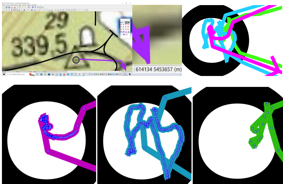
Obrázek č. 24 Statické měření na trigonometrickém bodě, vnitřní poloměr kroužku je 2 m, vnější 3 m.
