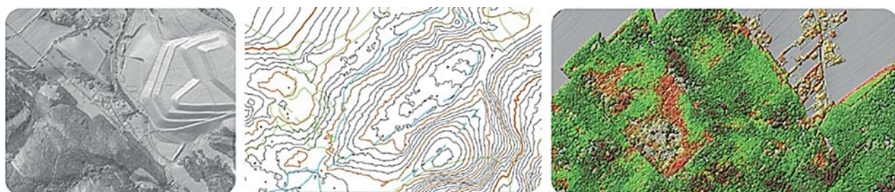
Obr. 6 Odvozeniny LLS: stínovaný model povrchu Radvanice, Česko (vlevo), vrstevnice a vyhodnocení vegetace Longchaumois, Francie (uprostřed), stínovaný model výšky vegetace a budov Fürstenfeld, Rakousko (vpravo)
